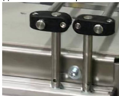
Крепеж для установки датчиков и сканеров
