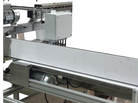
V-образный конвейер для сбора пачек
