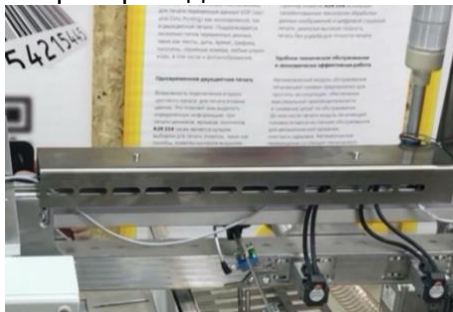
Система отбраковки с сервоприводом
