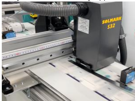
Система печати Solmark S32 с чернилами УФ отверждения
